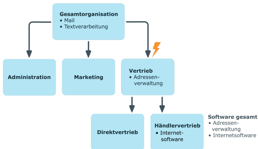
Abbildung 3: Unterbrechung der Vererbung in einer Top-Down-Vererbung
