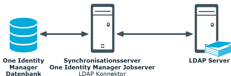
Abbildung 1: Architektur für die Synchronisation
