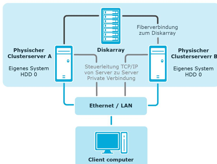
Dieser Cluster besteht aus 2 physikalischen Maschinen "Server A" und "Server B", die ein gemeinsames Diskarray nutzen und jeweils über eine eigene Systemfestplatte verfügen. Jeder Server ist mit einem Windows Betriebssystem ausgestattet. Beide Server sind identisch installiert, so dass im Falle eines Ausfalls der eine Server die Arbeit des anderen Servers übernehmen kann.
