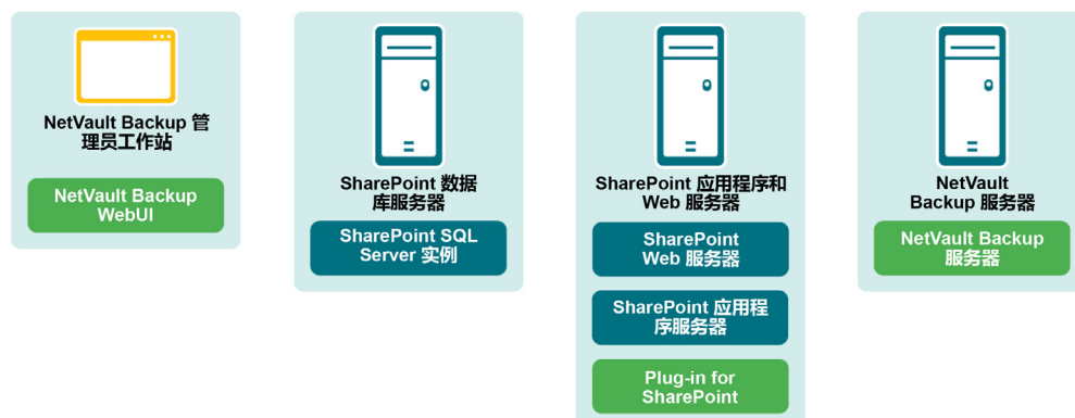
图 2. 以小型服务器场部署方式部署插件
