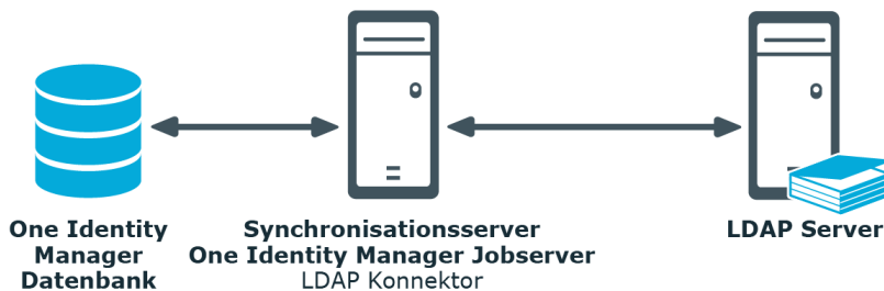
Abbildung 1: Architektur für die Synchronisation
