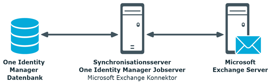
Abbildung 1: Architektur für die Synchronisation
