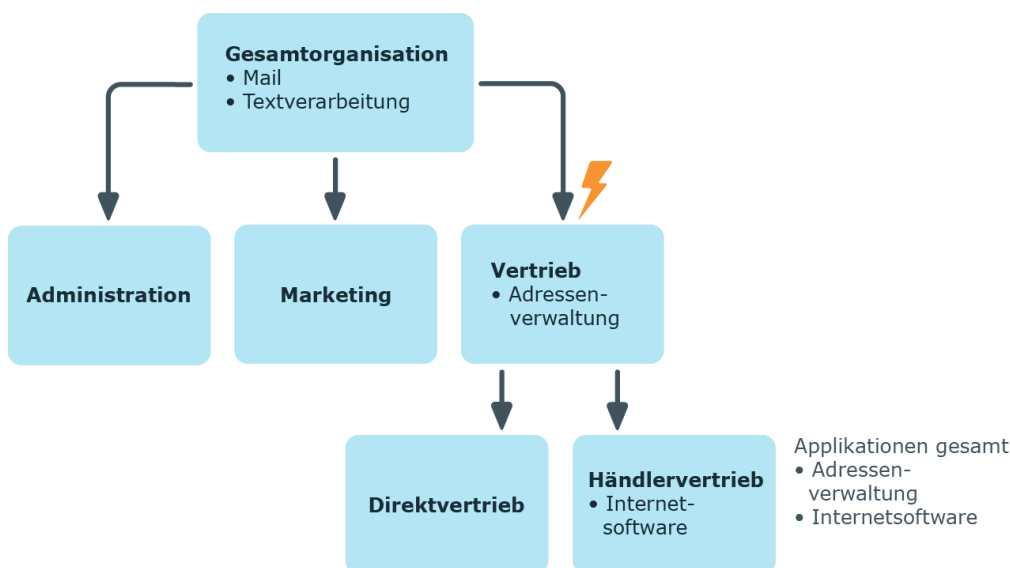
Abbildung 3: Unterbrechung der Vererbung in einer Top-Down-Vererbung
