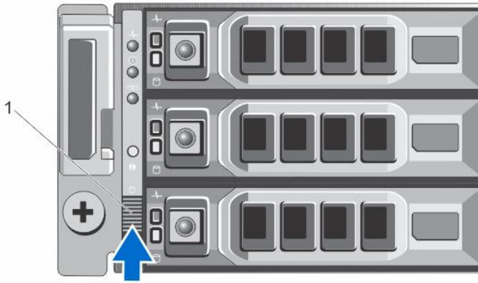
그림 1. PowerVault MD1400 스토리지 인클로저 구성 스위치 설정
