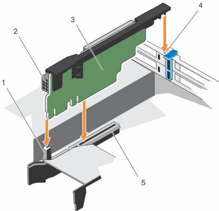
**Figure 58. Installation de la carte de montage pour carte d'extension 3**
