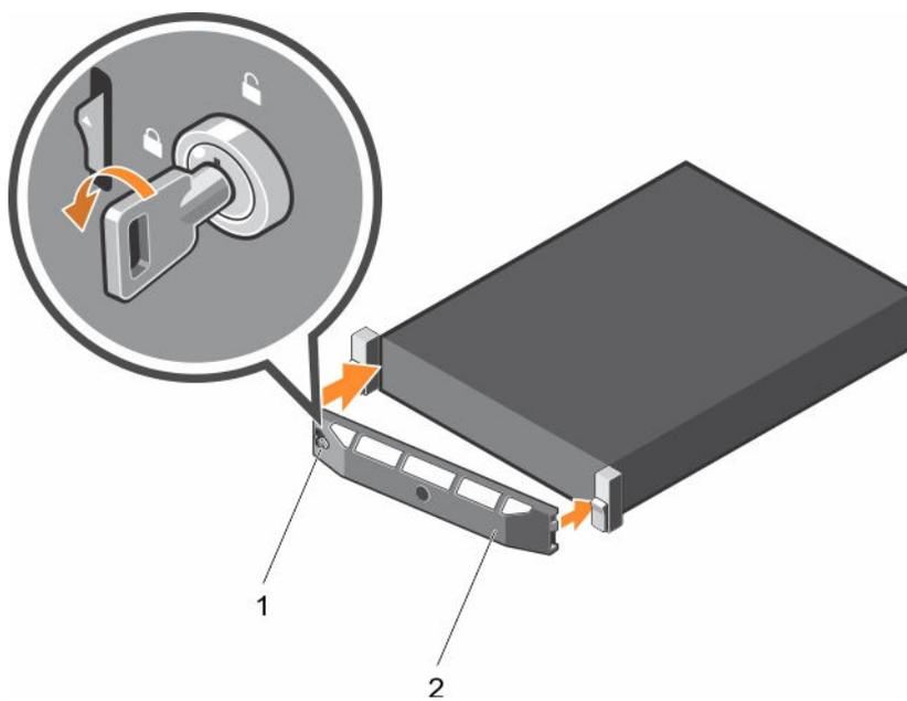
**Figure 10. Installation du cadre avant optionnel**
