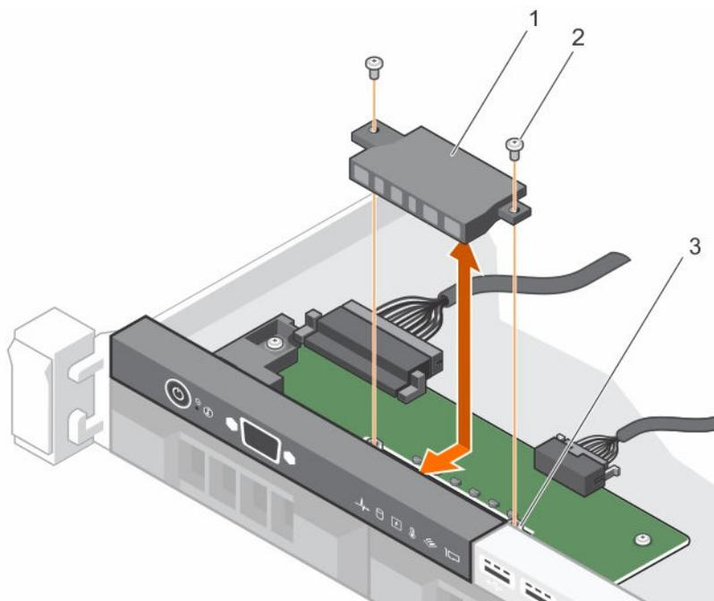
**Figure 88. Retrait et installation du module de LED – châssis à quatre disques durs câblés**
