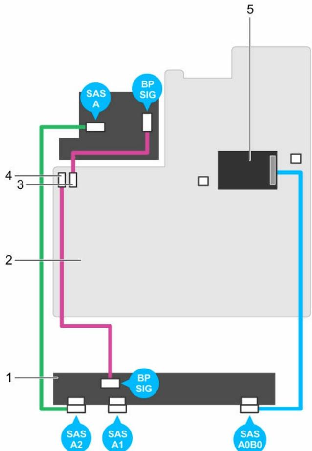
**Figure 79. Schéma de câblage : fond de panier de 3,5 pouces (x12) (option 1)**
