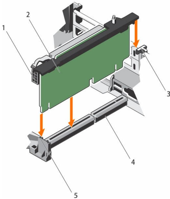
**Figure 57. Installation de la carte de montage pour carte d'extension 2**
