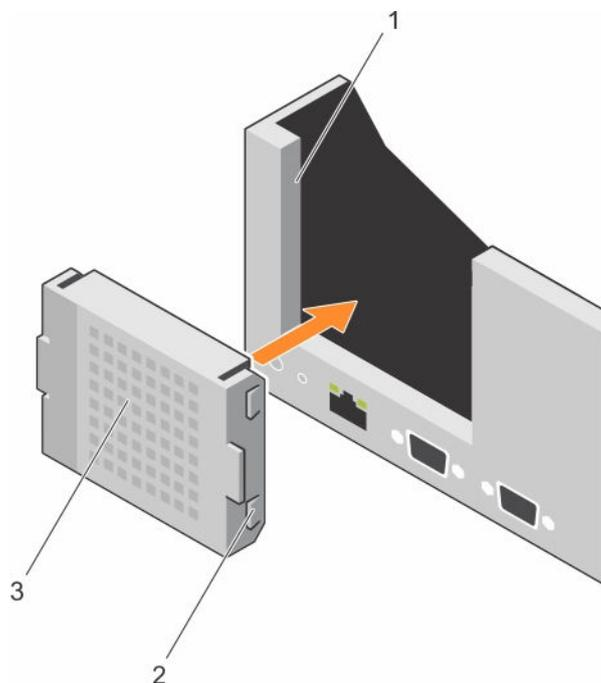
Figure 48. Installation du cache de la carte de montage 1
