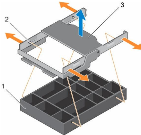
Figure 19. Retrait du cache de disque dur d'un support de disque dur
