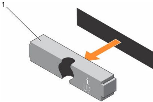
Figure 69. Retrait et installation d'un cache de disque dur de 2,5 pouces (arrière)
