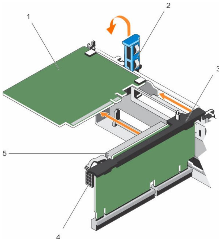
**Figure 43. Retrait d'une carte d'extension dans la carte de montage pour cartes d'extension 2 ou 3**
