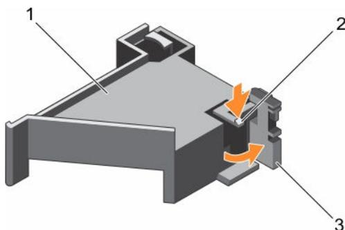
**Figure 37. Ouverture du loquet du support de carte PCIe**
