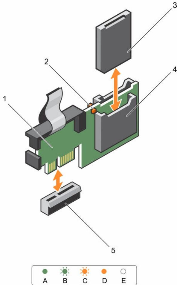
**Figure 60. Retrait et installation du module SD interne double (IDSMD)**
