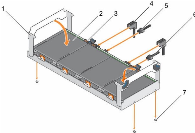
**Figure 18. Installation plateau de disque dur**
