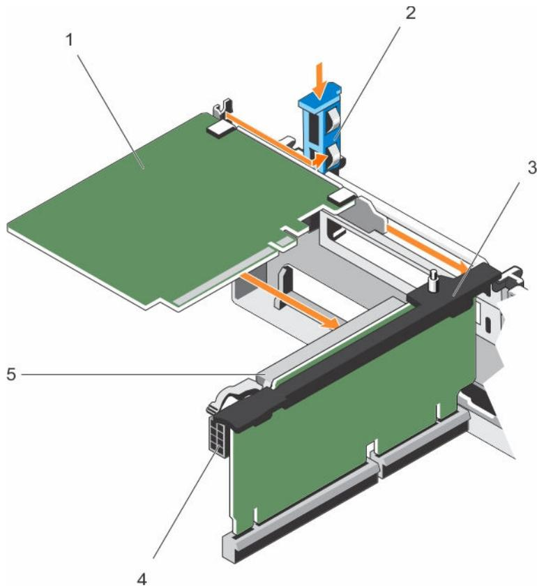
**Figure 44. Installation d'une carte d'extension dans la carte de montage pour carte d'extension 2 ou 3**
