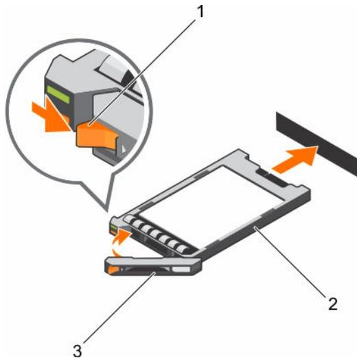
Figure 77. Installation d'un SSD uSATA de 1,8 pouce remplaçable à chaud
