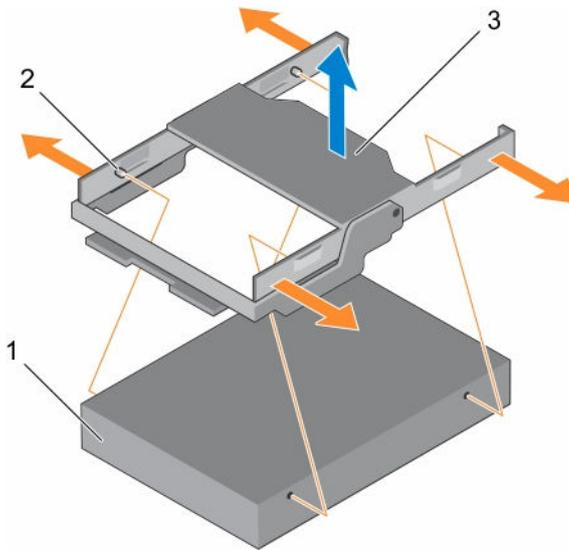
Figure 23. Retrait du disque dur d'un support de disque dur
