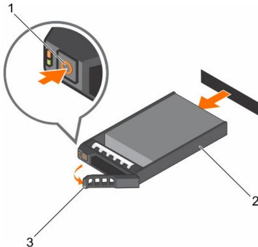
Figure 75. Retrait et installation d'un disque dur remplaçable à chaud
