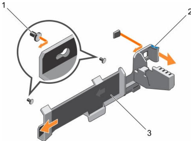
**Figure 39. Retrait du support de fixation des câbles**
