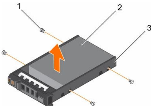
**Figure 73. Retrait d'un disque dur d'un support de disque dur**
