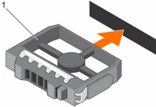
**Figure 72. Installation d'un cache de disque dur 3,5 pouces**
