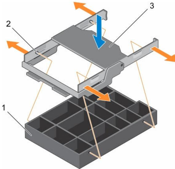
Figure 20. Installation d'un cache de disque dur dans un support de disque dur
