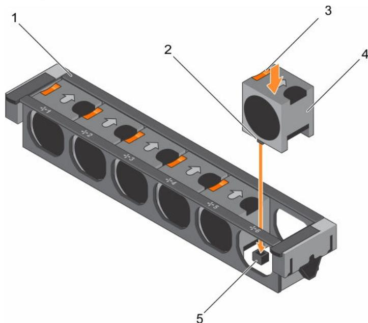
Figure 27. Installation d'un ventilateur de refroidissement
