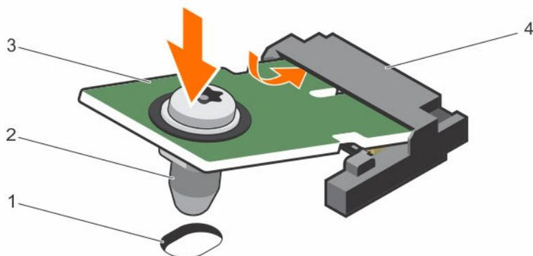
**Figure 93. Installation du TPM**
