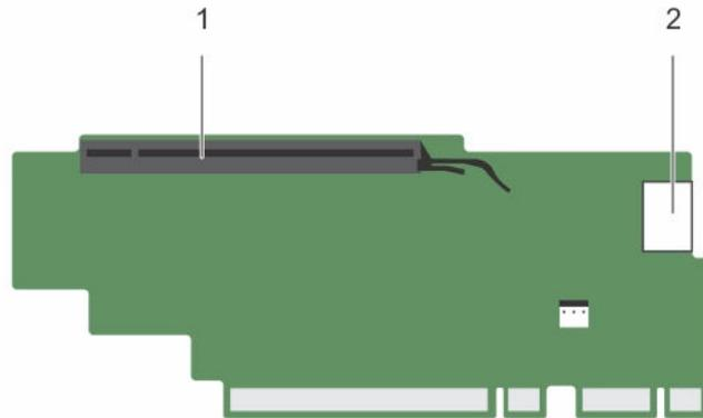
Figure 55. Identification des connecteurs de la carte de montage pour carte d'extension 3 (alternative).
