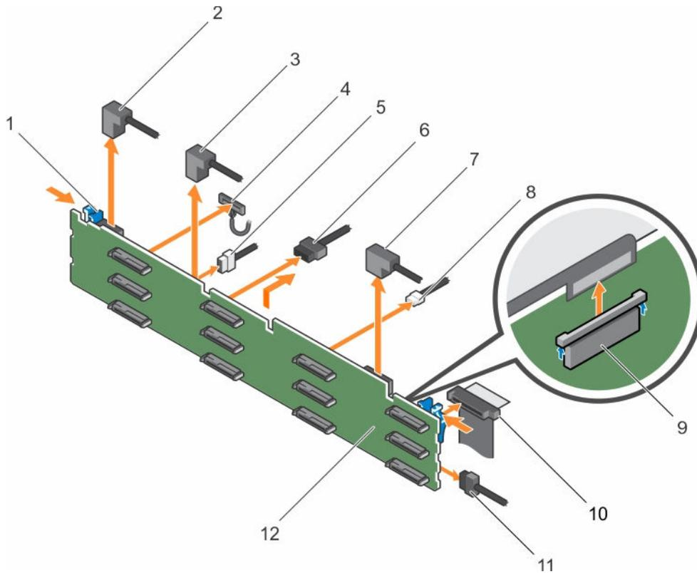
**Figure 78. Retrait et installation du fond de panier de 3,5 pouces (x12)**
