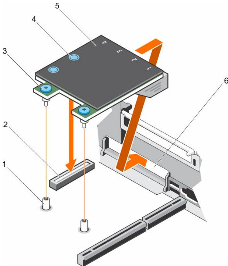
**Figure 62. Installation de la carte fille réseau**
