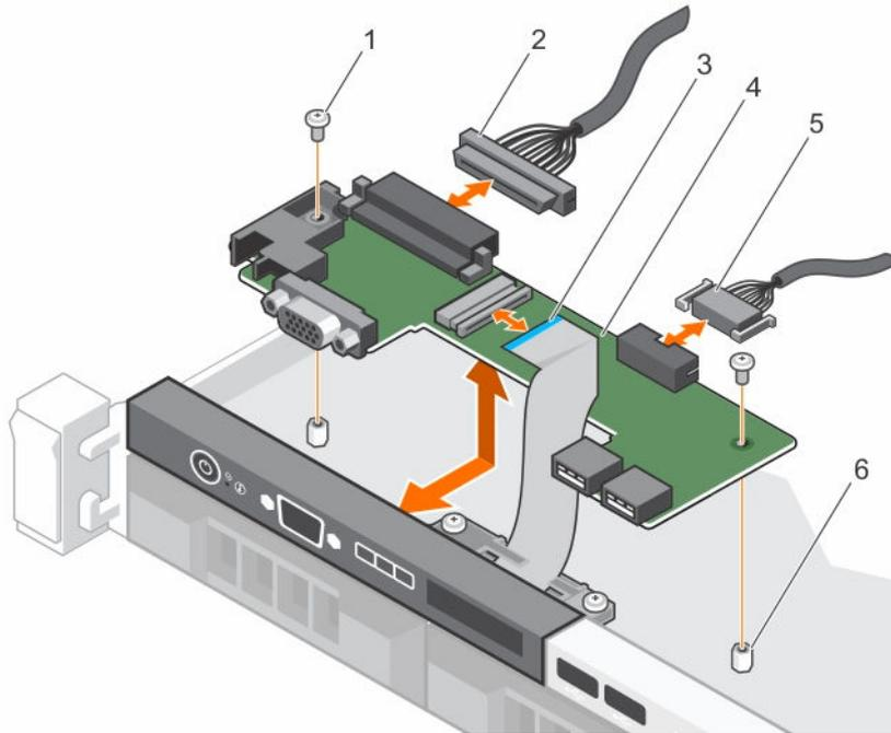
Figure 87. Retrait et installation de la carte du panneau de commande LCD module de panneau de commande – châssis à quatre disques durs
