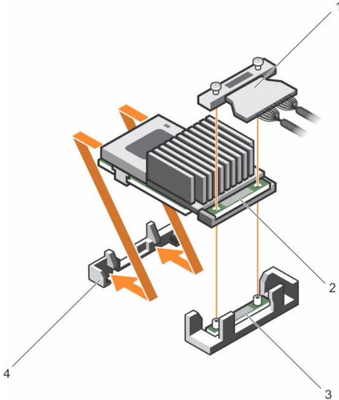
**Figure 42. Installation de la carte contrôleur de stockage intégrée**
