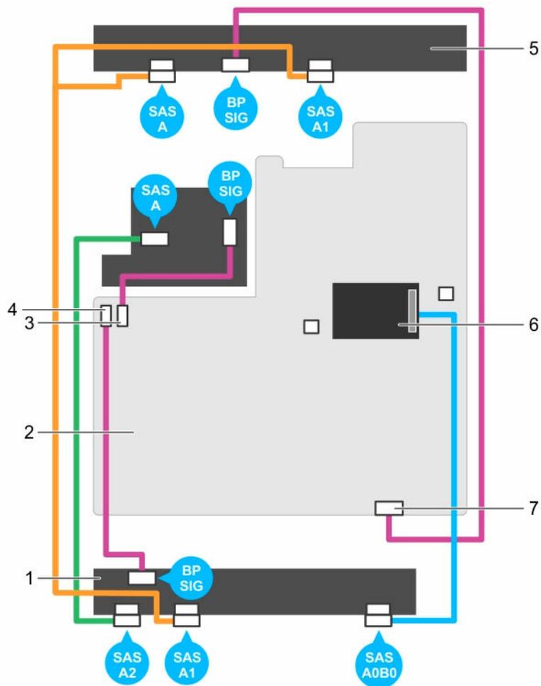
**Figure 80. Schéma de câblage : fond de panier de 3,5 pouces (x12) (option 2)**
