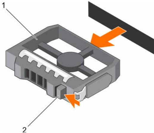
Figure 71. Retrait d'un cache de disque dur 3,5 pouces
