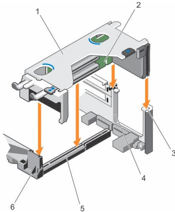
**Figure 56. Installation de la carte de montage pour carte d'extension 1**
