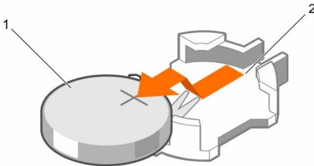
**Figure 63. Retrait de la pile du système**
