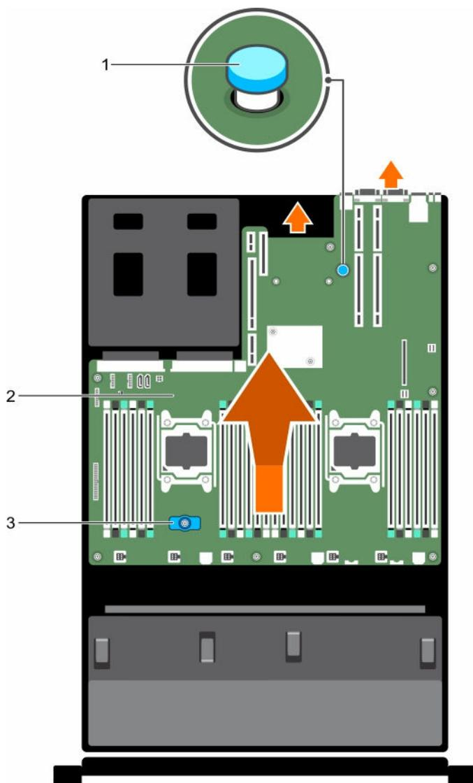
Figure 92. Installation de la carte système
