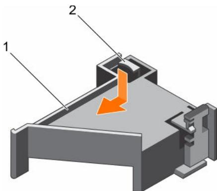
**Figure 36. Installation du support de carte PCIe**
