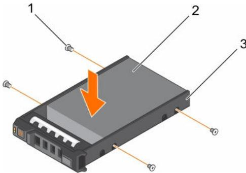
Figure 74. Installation d'un disque dur dans un support de disque dur
