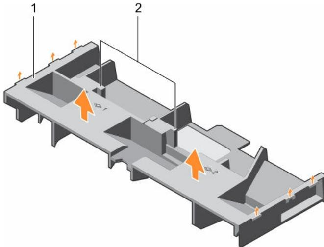
Figure 15. Retrait du carénage de refroidissement
