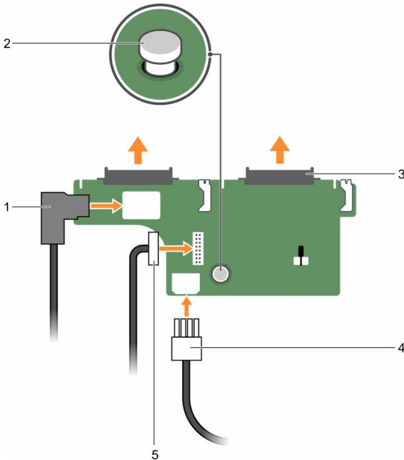
Figure 85. Installation du fond de panier de disque dur (x2) de 2,5 pouces
