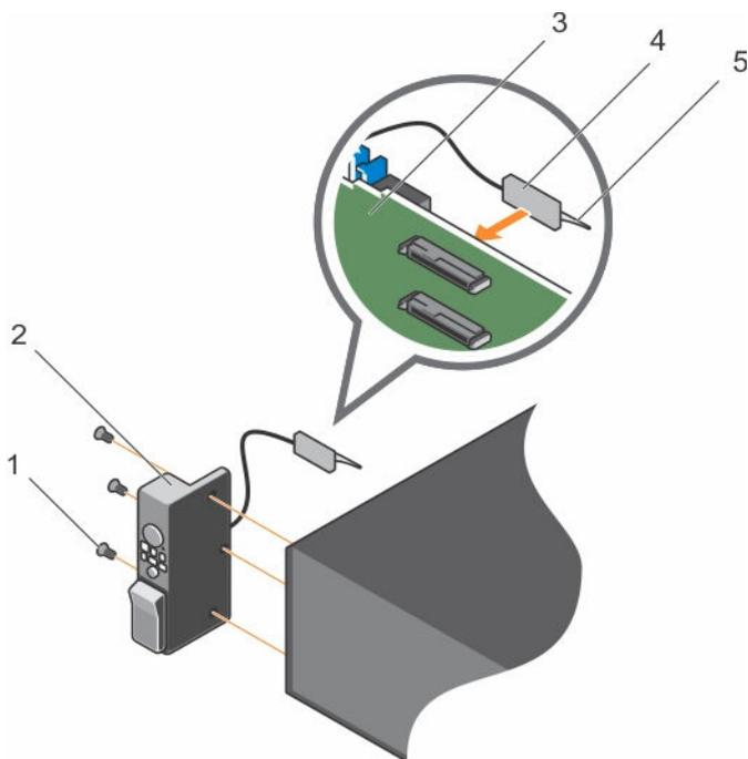
**Figure 90. Installation du panneau de commande**
