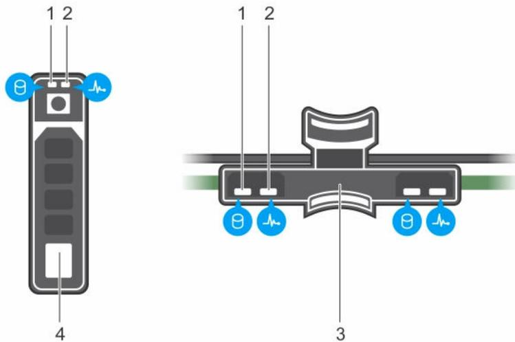
**Figure 3. Voyants de disque dur sur le disque dur et le fond de panier du plateau du disque dur**
