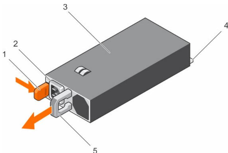
Figure 67. Retrait d'un bloc d'alimentation (PSU) CA
