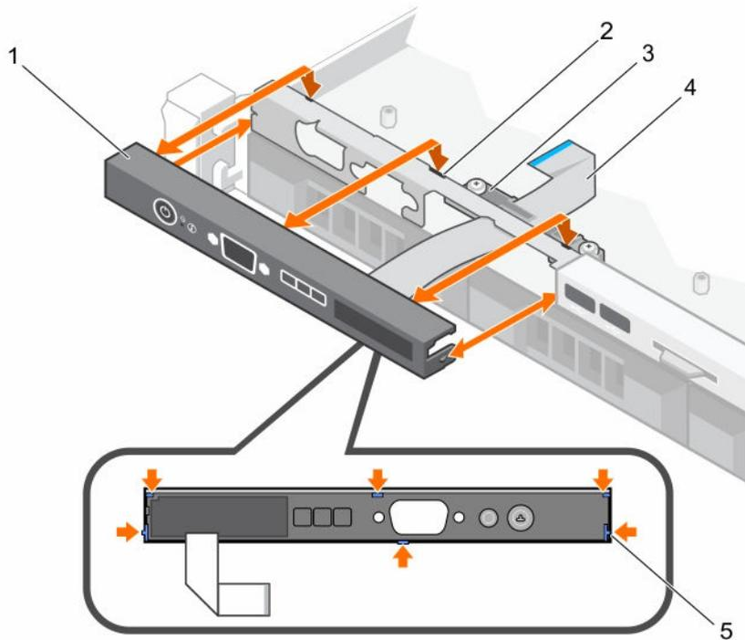
**Figure 86. Retrait et installation du panneau de commande LCD – châssis de quatre disques durs 3,5 pouces remplaçables à chaud**
