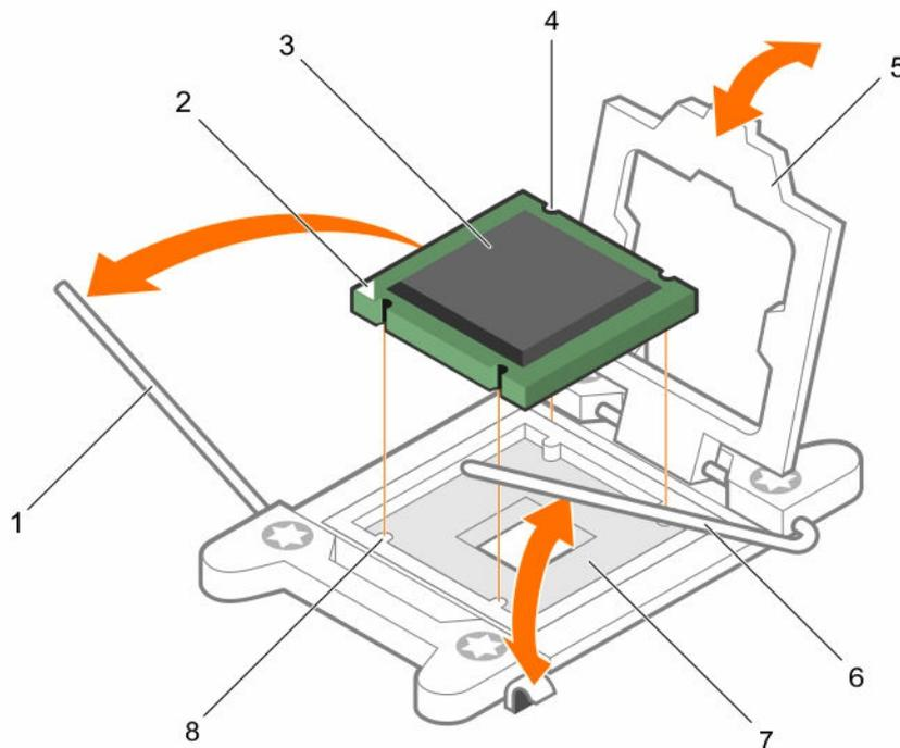
**Figure 34. Installation d'un processeur**
