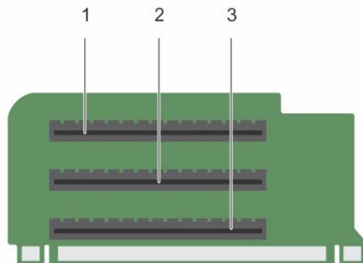
**Figure 50. Identification des connecteurs de la carte de montage pour carte d'extension 1**
