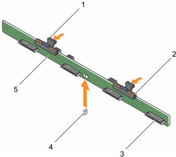
Figure 25. Retrait du fond de panier de disque dur (x4) de 3,5 pouces
