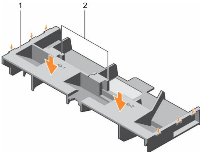
Figure 16. Installation du carénage de refroidissement
