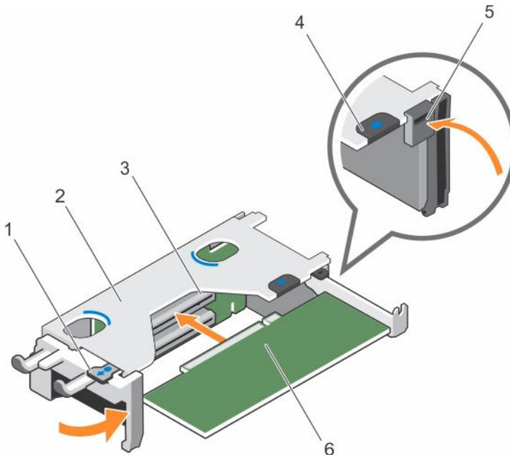
**Figure 46. Installation d'une carte d'extension dans la carte de montage 1 pour carte d'extension**
