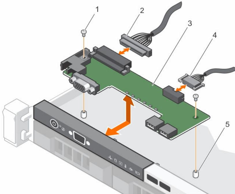
**Figure 89. Retrait et installation de la carte du panneau de commande – châssis de quatre disques durs câblés**
