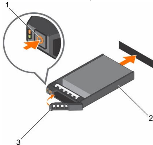
**Figure 76. Installation d'un disque dur remplaçable à chaud**
