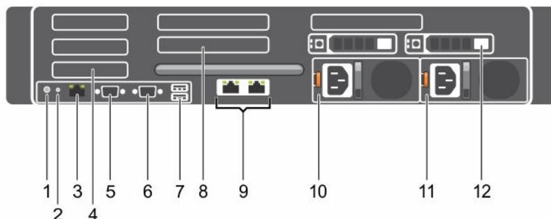
**Figure 2. Voyants et caractéristiques du panneau arrière : DL4300**
