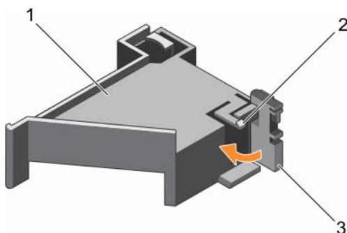
**Figure 38. Fermeture du loquet du support de carte PCIe**
