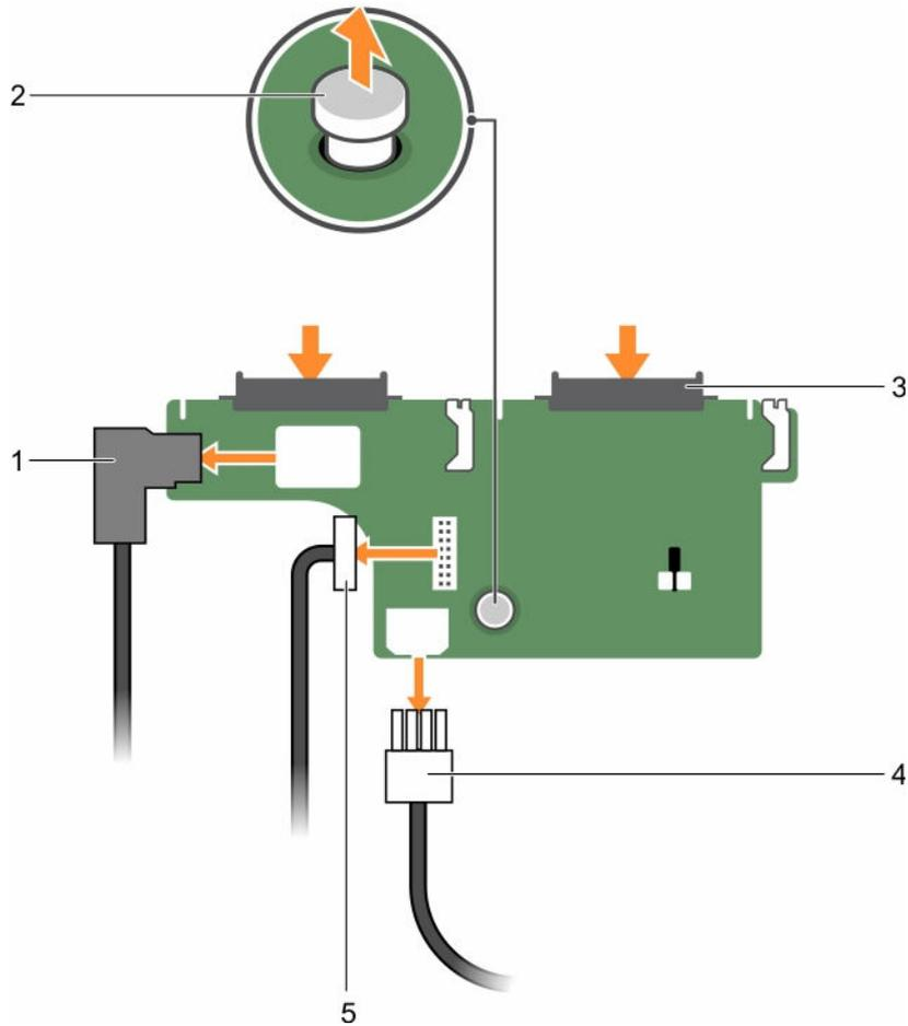
**Figure 84. Retrait du fond de panier de disque dur (x2) de 2,5 pouces**
