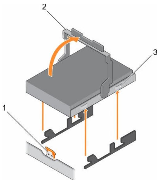
Figure 21. Retrait d'un disque dur installé dans un plateau de disque dur
