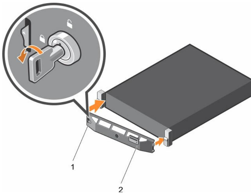
**Figure 11. Installation du cadre Quick Sync**
